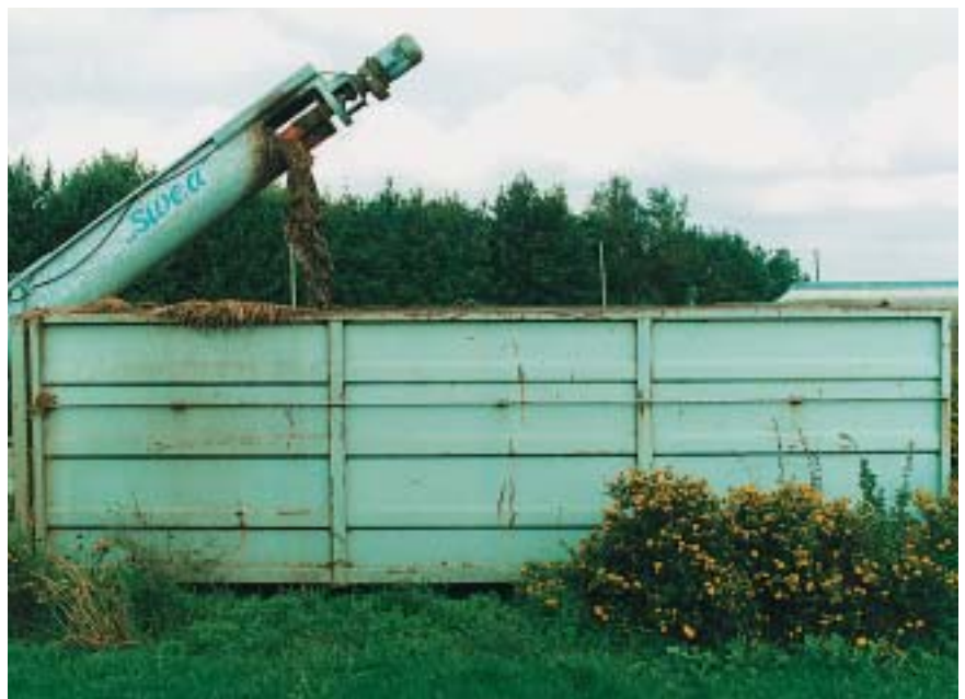
Svea-sneglen transporterer gødningen op i en flytbar container
