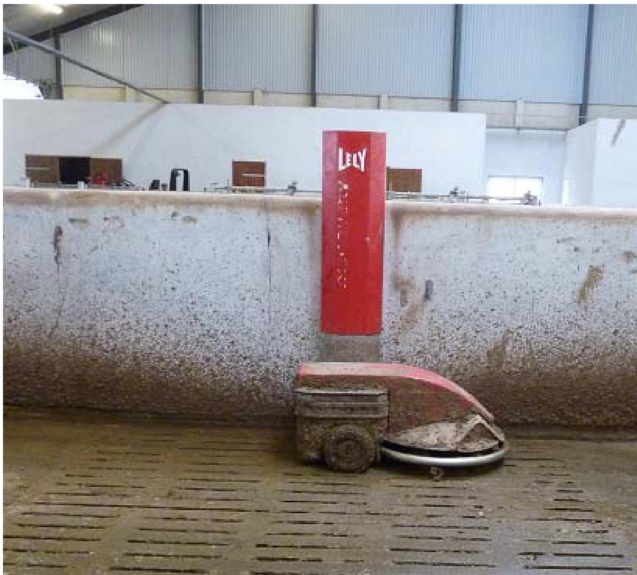
Billede 2. Robotskraber kørt til opladeren, hvor den opholder sig cirka 50 % af tiden.
