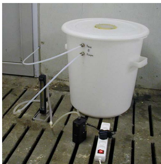
Fig 5.2 Udtagning af lugtprøve. Prøveslangen er ført gennem væg fra gang til staldsektion
