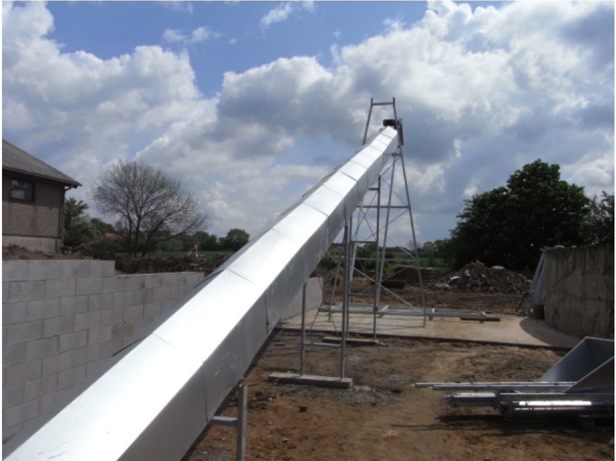
Figur 5. Tværbåndet fra stalden ender typisk i en udlægger, som lægger gødningen i en vogn.
